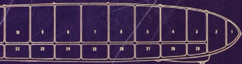
GAZELLE ANORDNUNG GAS CELL ARRANGEMENT TRAGGASZELLEN (WASSERSTOFF) HYDROGEN LIFTING GAS KRAFTGASZELLEN (BLAUGAS) PROPANE ENGINE FUEL
